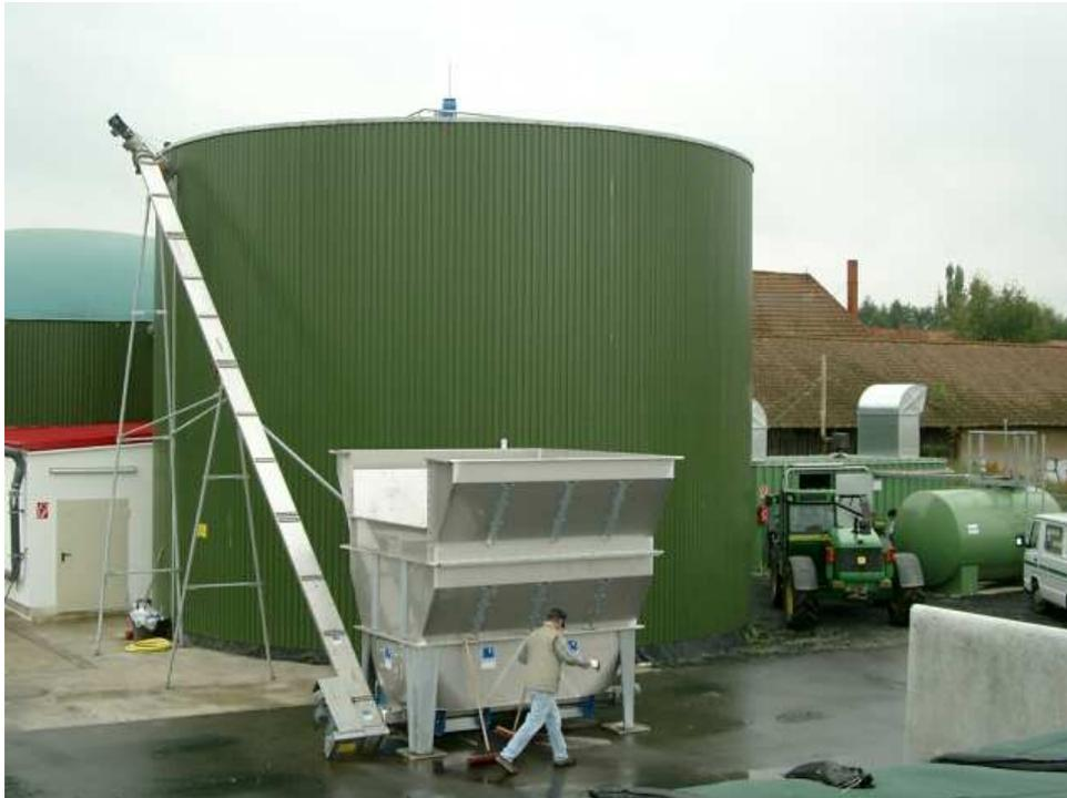
Abb. 3: Feststoffeintragstechnik in den Fermenter
