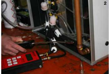
1 Josef Jerg hat die zweitägige Schulung absolviert und betreibt mit seinem Sohn zusammen die Biogasanlage. I 2 Mit Hilfe dieses Sensors können undichte Stellen in den Gasleitungen aufgespürt werden. I 3 Leitungen und Hähne sind beschriftet, ... I 4 ... die explosionsgefährderten Regionen gekennzeichnet... I 5 ... und Anlagenteile, die von Unbefugten nicht betreten werden dürfen, entsprechend abgesichert. I Fotos: Mayer
